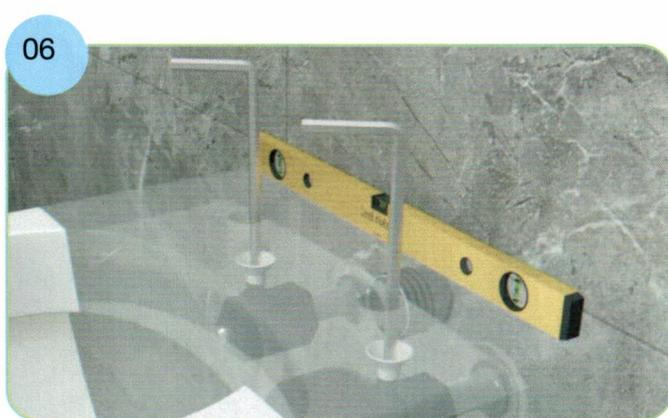
Befestigen Sie die Toilette mit der Madenschraube, verwenden Sie hierzu den Inbusschlüssel (B).
